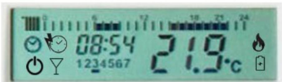
⌚ وضعیت زمانبندی (AUTO) ترمومترات با استفاده از الگوی گرمایشی پیش فرض و یا تعريف شده توسط کاربر در زمان های مشخص، سیستم گرمایش را روشن یا خاموش می کند.
